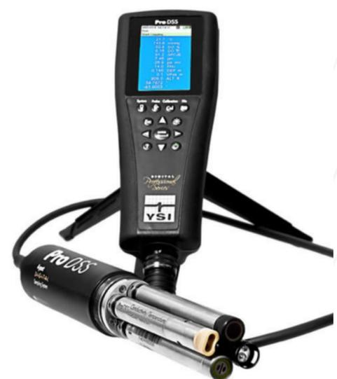
Figura 2. Sonda multiparámetros. Obtenido de: <http://bit.ly/3qj534J>
